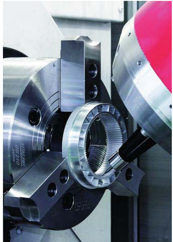
図6. 複合加工機による内歯車の加工
